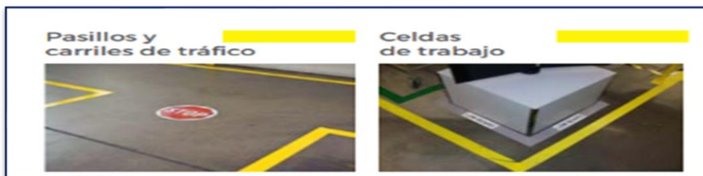
Ilustración 2: Marcaje para delimitar pasillos y carriles de tránsito de trabajo
